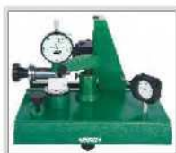
vérifier la répétabilité des indicateurs à cadran
