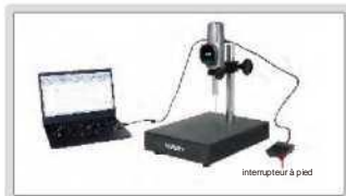
données transmises à Excel sans logiciel : appuyer brièvement sur l'interrupteur à pied pour transmettre les données, appuyer longuement sur zéro
