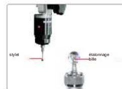
sonde (en option), comprend un stylet de Ø2 mm et Ø3 mm. Une bille d'étalonnage de Ø25 mm, la précision de mesure est de 10 µm
