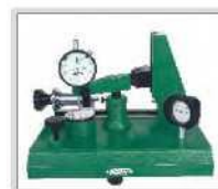
vérifier l'effet de la force latérale sur la précision des indicateurs à cadran (un bloc pour jauge demi-rond est nécessaire)
